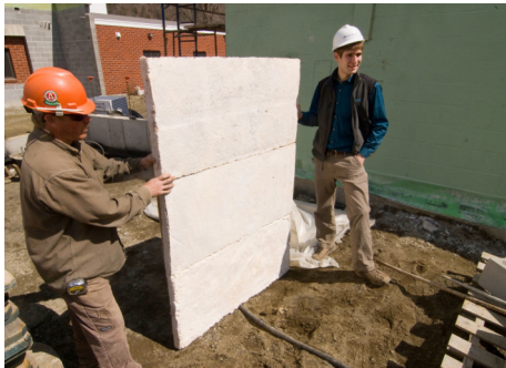
↑ Panneau d'isolation thermique en mycélium développé par Ecovative – Wikipédia
